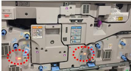
Neue Transferrollen aus Urethan ermöglichen die Verwendung eines breiteren Medienspektrums.
